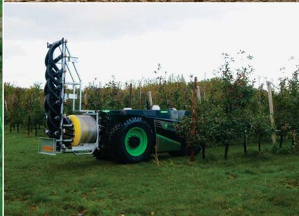
**AgBot 2.055W3** je zcela autonomní univerzální nosič nářadí pro sady a vinice. Po dané oblasti se pohybuje zcela samostatně a je schopen vykonávat 80% činností, které se běžně provádí standardním traktorem. Nejvíce opakované práce jako je mulčování, postřik, údržba příkmenného pásu a další jsou vykonávány s maximální přesností a efektivitou.
