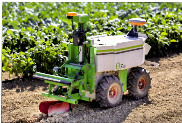
Naio OZ jsou malé kompaktní stroje pro malé zelinářské provozy a speciální plantáže. Do zadního závěsu je možné připojit rozličné druhy nářadí
