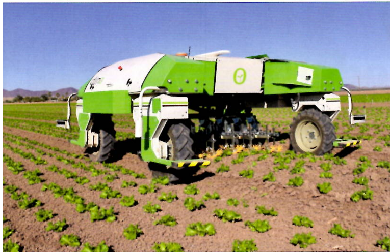
Velké modely robotů s označením Dino jsou vhodné i pro pěstování zelenin na větších výměřích. Mohou pod svým krytem nést robotickou plečku, která kypří nejen meziřádkové prostory, ale také oblasti mezi rostlinami v řádku
