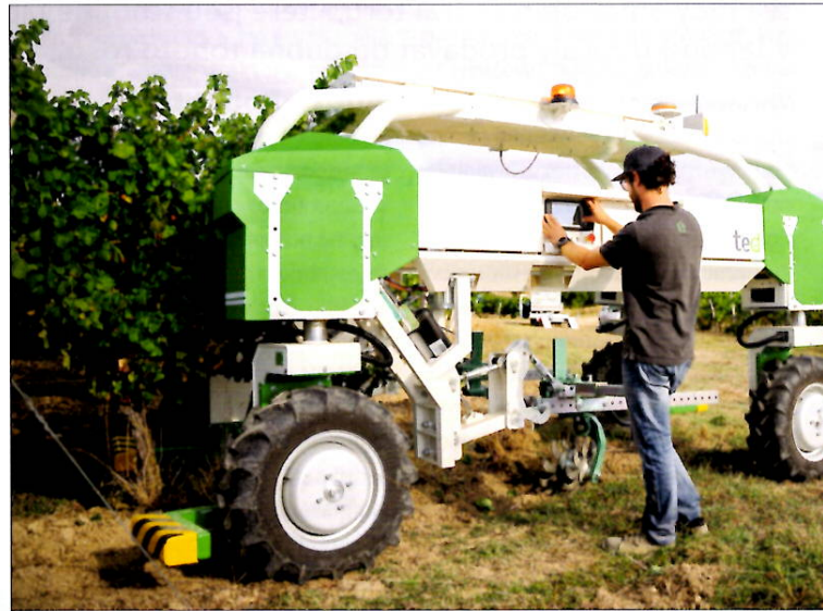
Na integrovaném terminálu se před začátkem práce nastaví AB navigační linie, počet řádků od ní vpravo a vlevo, dále také to, kolikrát má robot zadaný pozemek zpracovat
