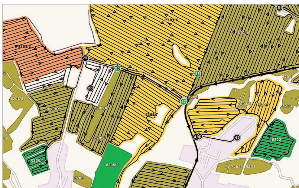
Příklad práce samojízdného postřikovače. Tento náhled umožňuje agronomovi perfektní kontrolu z pohodlí kanceláře. Vidí, zda byly i všechny tvarově složitější pozemky kompletně ošetřeny a v kterou dobu. Současně lze zkontrolovat dodržení pojízdné rychlosti postřikovače. Barevně rozlišené parcely znázorňují různé plodiny
