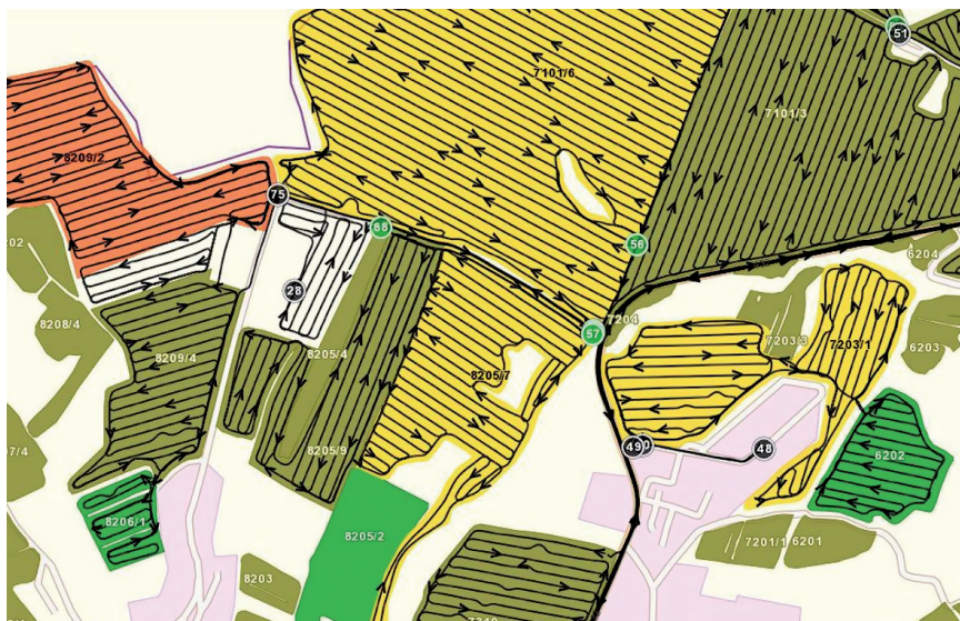
Příklad práce samohodného postřikovače. Tento náhled umožňuje agronomovi perfektní kontrolu z pohodlí kanceláře, zda byly i všechny tvarově složitější pozemky kompletně ošetřeny a v kterou dobu. Současně je možno zkontrolovat dodržení pojezdové rychlosti postřikovače. Barevně rozlišené parcely znázorňují různé plodiny.
