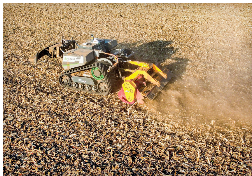
Ukazuje se, že roboty jsou vhodné pro opakující se činnosti, jako je právě zpracování půdy nebo mulčování, a lze je provozovat v praxi
