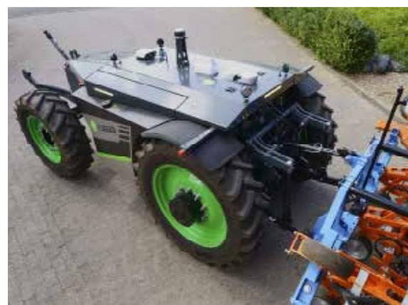
**AcBOT 2.055W4** je zcela autonomní univerzální nosič nářadí nahrazující lehký polní traktor. Po půdním bloku se pohybuje zcela samostatně a je schopen vykonávat práce, které se běžně provádí standardním traktorem. Velmi lehká konstrukce a sofistikovaný a přesný pohyb po půdním bloku jej předurčuje k přesným pracím jako je zejména setí a plečkování řádkových plodin.
